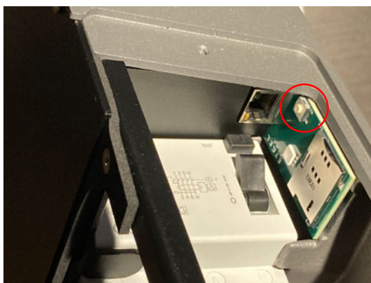
Figure 8 : Bouton de réglage du courant à l'intérieur de la porte de maintenance
