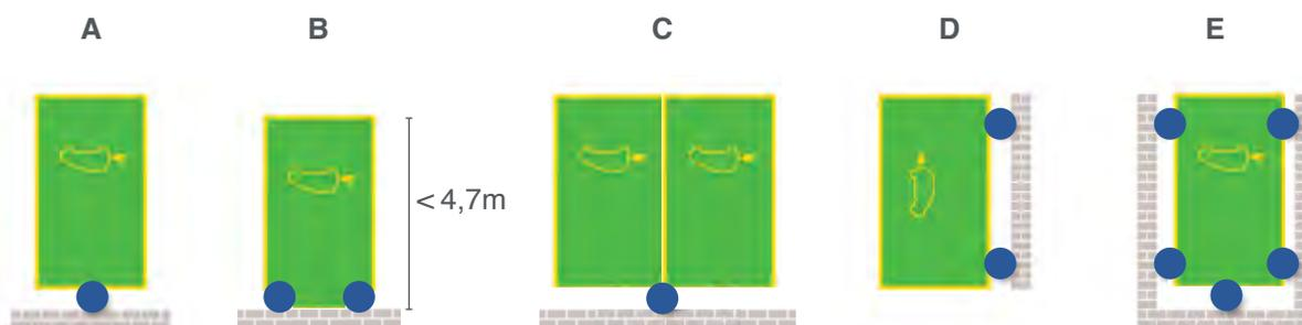
Dans le cas d'une borne de recharge installée pour deux véhicules pour deux places de parking, nous recommandons la pose de la borne, de façon centrale à ce qu'elle puisse desservir les deux places de parc (Fig. C).
